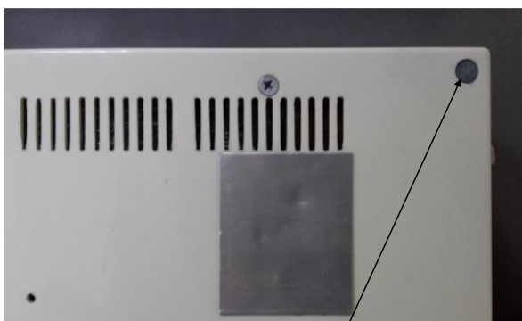
Место пломбировки панельного компьютера
